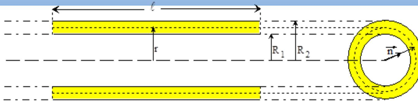
En régime permanent, la paroi interne de rayon  $R_1$  est à  $T_1$  et la paroi externe de rayon  $R_2$  est à  $T_2 < T_1$  (conduite d'eau chaude par exemple). La chaleur se propage radialement de l'intérieur vers l'extérieur.
